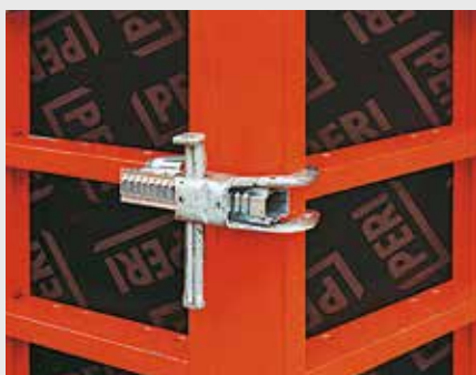
BFD 얼라인먼트 커플러는 평면 판넬 조인트와 외부 코너에서 모두 사용됩니다.
